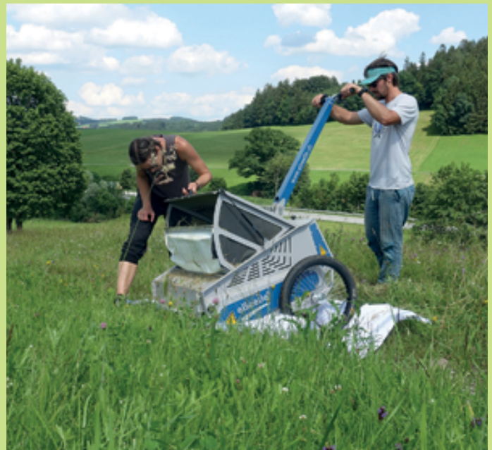
Die Entleerung des Ernteguts beim eBeetle 2.0 erfolgt durch Hochheben des Sammelbehälters, wodurch das geerntete Material nach unten auf ein vorbereitetes Leintuch herausrutschen kann.
